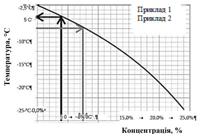
Рисунок 3 — Графік залежності між температурою замерзання та концентрацією розчину натрію хлориду
