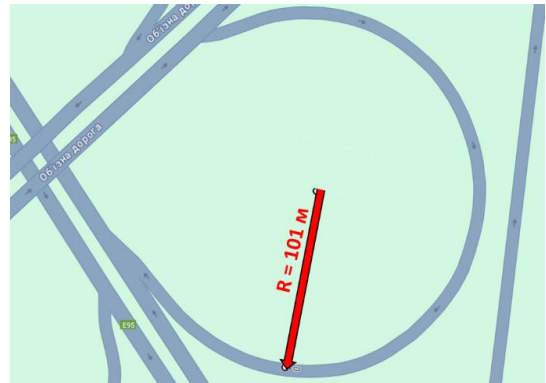
Рисунок 6 — Радіус заокруглення правоповоротного заїзду та з'їзду на дворівневу транспортну розв'язку типу «лист Конюшини» у м. Одеса
