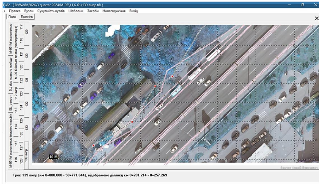
Рисунок 11 — Приклад виявлення неприпустимих перетинів структурних ліній 129 та 139
