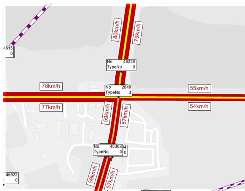
Рисунок 7 — Епюра поточної швидкості легкових автомобілів у завантаженій мережі
