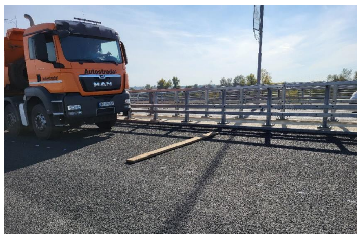
Рисунок 2 — Загальний вигляд проїзду транспортного засобу через перешкоду для посилення імпульсу
